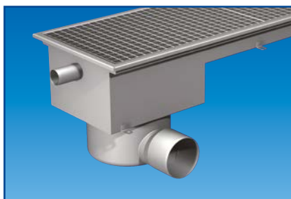
Innløp Ø 32, Ø 40 eller Ø 50 mm glattstuss plassert i siden på rennen.
