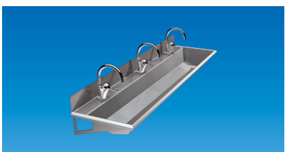
TVÄTTRÄNNA FR 405: Rostfri kvalitet EN 1.4301, vänster- eller högerplacerat avlopp, längd 1200 mm, 1800 mm, 2400 mm, 3000 mm.
