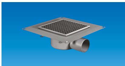
GOLVBRUNN FURO 105: Syrafast kvalitet EN 1.4404, sido- eller bottenutlopp.
